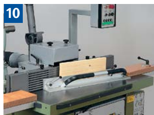
10 Einsetzfräsen kleiner Werkstücke mit Spannlade und Rückschlagsicherung.
