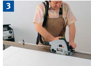
3 Einsetsägen mit Tauchkreissäge und Führungsschiene mit Anschlagnocken (als Rückschlagsicherung).
