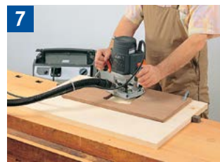
7 Einsatz der Handoberfräsmaschine mit Schablone.
