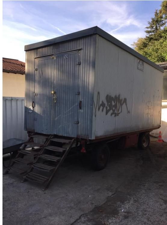
wegen desolatem Zustand muß leider der komplette Aufbau erneuert werden und das Fahrgestell des Anhängers restauriert werden
